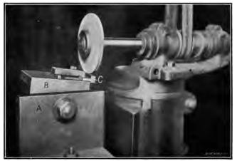
Fig. 10. Grinding Die Sections
